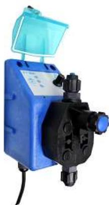
La proporción deseada de dosificación se logra enclavando el contactor del dosificador con el contactor de la bomba de agua. Por lo tanto, cada vez que hay movimiento de agua hay dosificación. Como el caudal de la bomba de agua es constante, y al dosificador se lo ajusta a un % de caudal constante, proporcional al primero, siempre se mantiene las p.p.m. de hipoclorito de sodio en agua. Ver modelos F1-MA, F2-MA, FD, y ML
