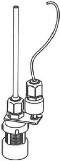
Una opción al solicitar el modelo F1-MA es el sensor de nivel. Este sensor permite detener el funcionamiento de la bomba dosificadora si la misma no cuenta con suficiente producto químico en el tanque de almacenamiento.
