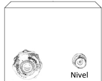
Cada vez que el sensor de nivel detecte la falta de producto químico en el tanque de almacenamiento se encenderá el led amarillo ubicado en el frente de la bomba dosificadora indicando falta de nivel suficiente para realizar la dosificación.
